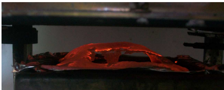
Essai cône calorimètre composite PBS/lin
