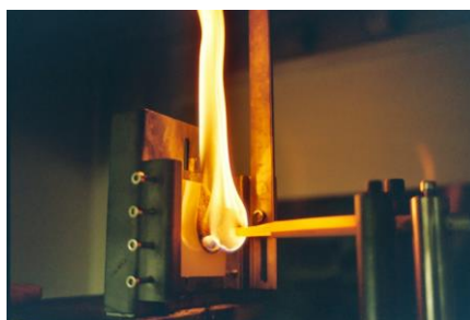
Photographie 1 : Exemple d'essai normalisé – CEI IC 60695-2-10 (Essais au fil incandescent).
